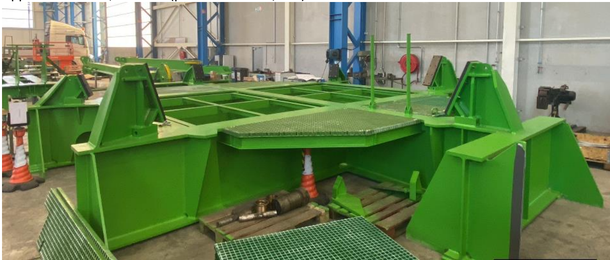
C4 – Saisissage d'équipement lourd 2 Approx 8m x 7 x 1,5m – 15t (profils HEB 1000/500)
