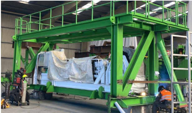
C2 – Berceau pour monopieu (4 pièces sur le navire) Approx 15m x 12 x 5m – 90t.
