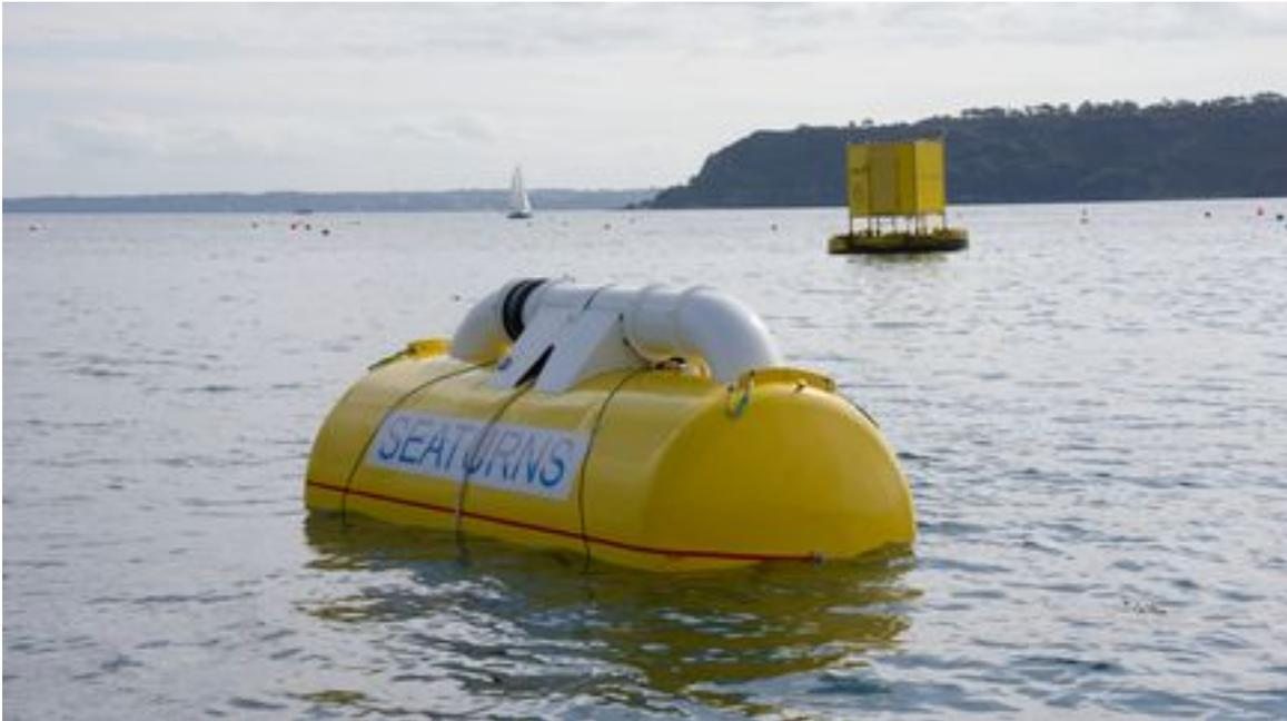
Le cylindre qui permet de produire de l'électricité en utilisant la force des vagues a été mis au point par la start-up bordelaise Seaturns. (IFREMER / OLIVIER DUGORNAY)
